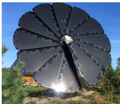
Till vänster: Solföljaren Smartflower på ETC Solpark i Katrineholm. Bild: ETC I mitten: Solcellsblomma sed framifrån. Plats: ETC, Katrineholm. Bildkälla: WSP Till höger: Släpvagn med solcellspaneler monterade. Bildkälla: Solcellsproffsens facebookside.
