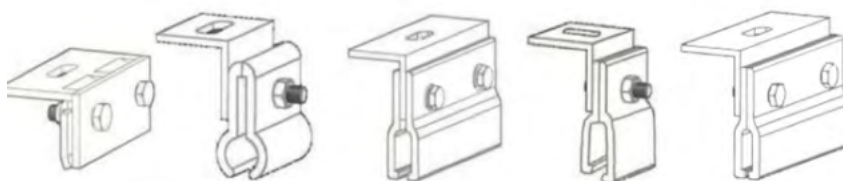
Olika typer av falsklämmor på olika falsar. Sol i väst, Installation och slutbesiktning 2018.
