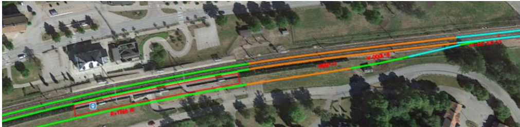
Figur 42 Ny växel öster om plattform
