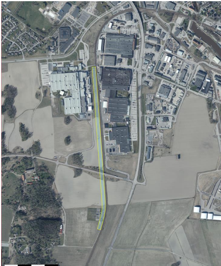
Figur 59 Placering av nytt mötesspår (långt) väster om Köping
