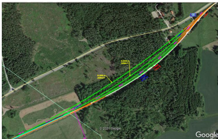
Figur 71 Spårskiss linjerätningar vid Kolbäck
