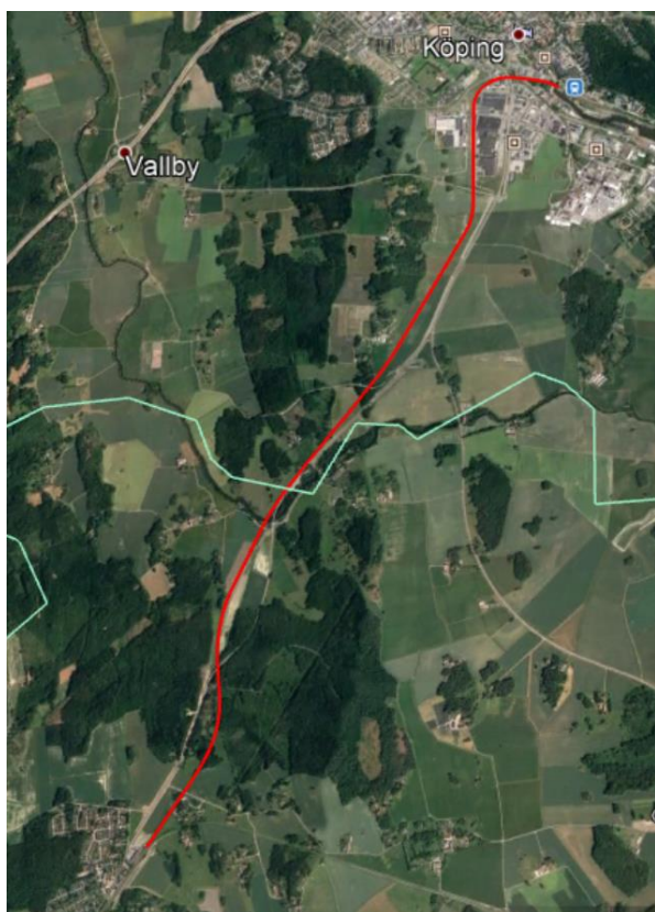
Figur 65 Sträcka som byggs ut till dubbelspår
